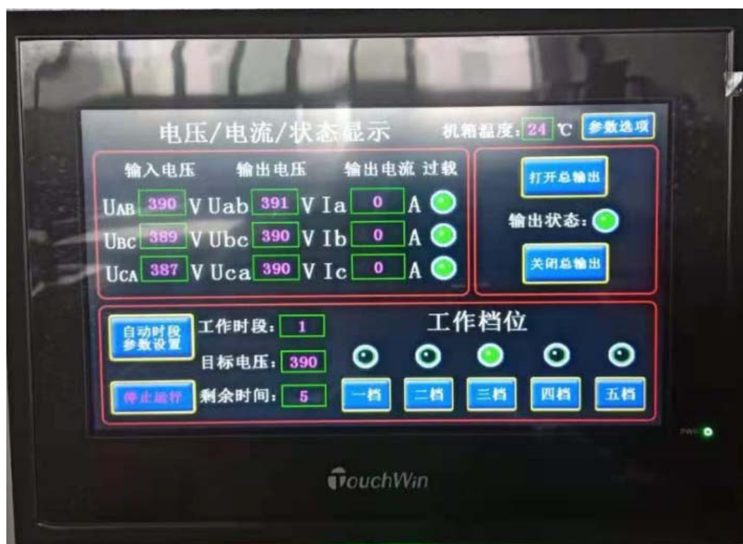
图六：SBW-ST 调压稳压器液晶触摸屏显示及按键说明
